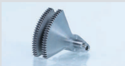
1 Alésage plus grand? 2 Rainure de clavette? 3 Taraudage? 4 Supprimer l'épaule?
